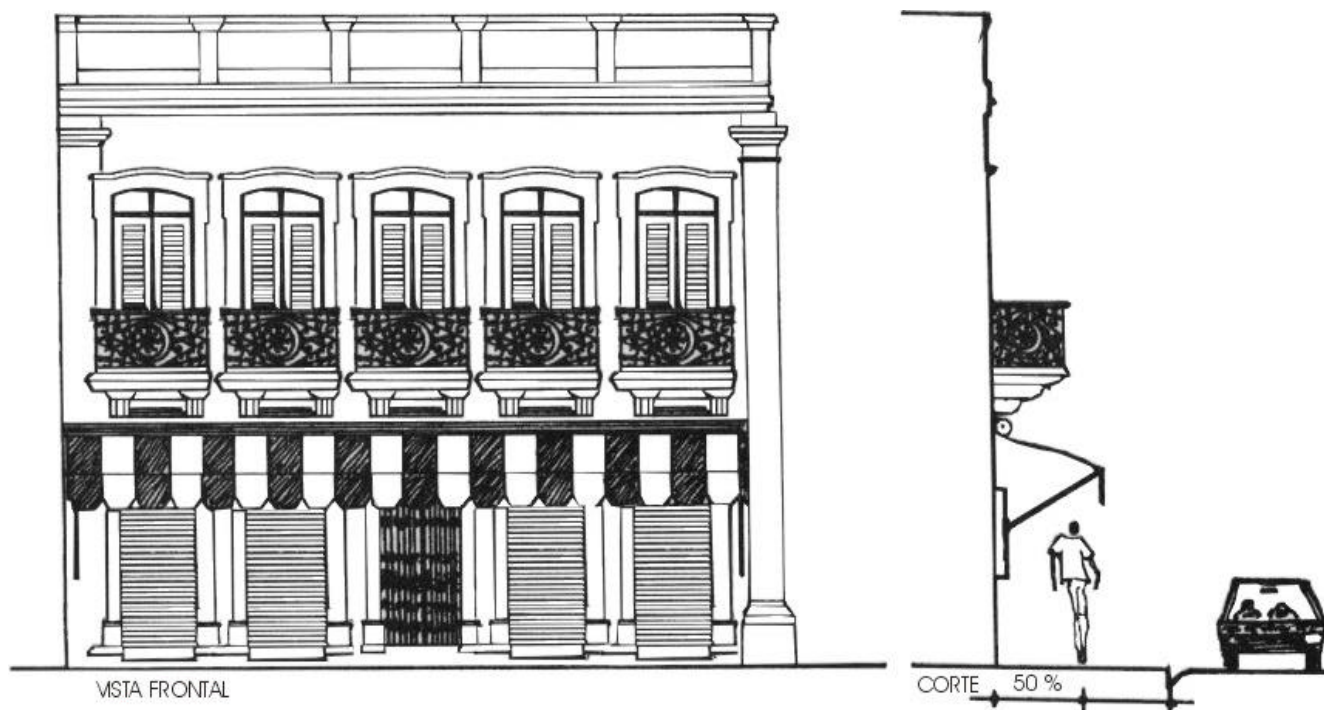
FIG. 06 – Toldos no alinhamento da fachada
